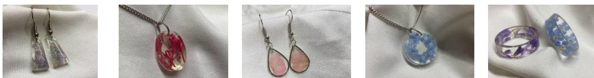
В качестве образцов для исследования были взяты небольшие изделия из эпоксидной смолы, которые были подвергнуты влиянию низкой и высокой температуры, действию ультрафиолетового излучения, воды, кислоты, щелочи, ацетона.
