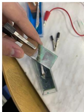
Рисунок 2. Покрытие медной пластины металлом с катода
