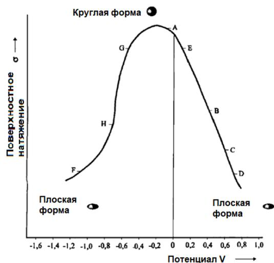
Рисунок 1. Зависимость поверхностного натяжения ртути от её электрического потенциала [3]
