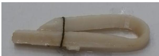
Рисунок 2. Образец после пластификации в 5% растворе соляной кислоты
