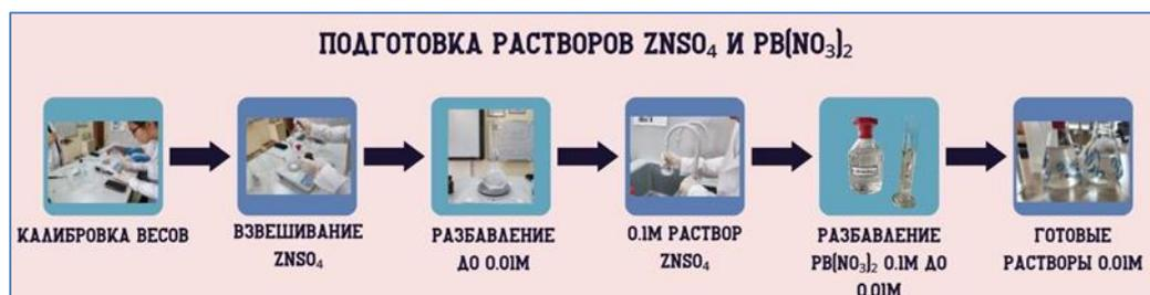
Рисунок 2. Приготовление стандартных растворов тяжелых металлов
