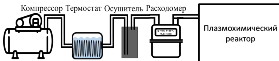
Рисунок 1. Схема экспериментальной установки для плазменной обработки бидистиллированной воды
