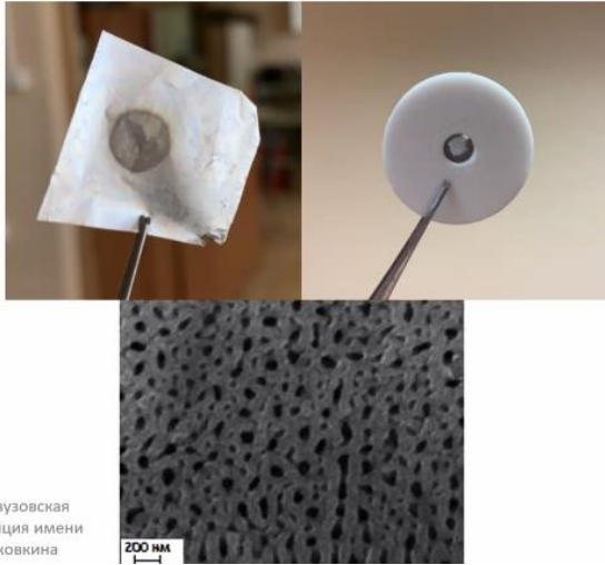
Мембраны ПАОА на тонкой фольге (11 мкм)
