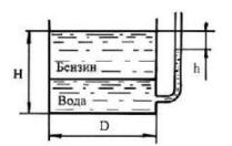
В цилиндрический бак диаметром 2 м до уровня H=1,5 м налиты вода и бензин. Уровень воды в пьезометре ниже уровня бензина на h=300 мм. Определить массу находящегося в баке бензина, если  $\rho_6=700$  кг/м<sup>3</sup>.
