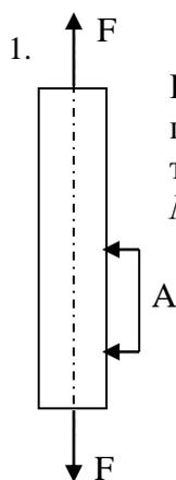
При растяжении силой  $F$  стрелка тензометра  $A$  с базой равной  $60$  мм, переместилась с деления  $5$  на деление  $9$ . Цена деления шкалы тензометра  $0,001$  мм. Модуль упругости материала образца  $E = 2 \cdot 10^5$  МПа. Чему равно напряжение в крайнем правом слое? (МПа)
