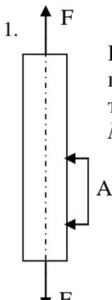
При растяжении силой  $F$  стрелка тензомера  $A$  с базой равной  $60$  мм, переместилась с деления  $5$  на деление  $9$ . Цена деления шкалы тензомера  $0,001$  мм. Модуль упругости материала образца  $E = 2 \cdot 10^5$  МПа. Чему равно напряжение в крайнем правом слое? (МПа)
