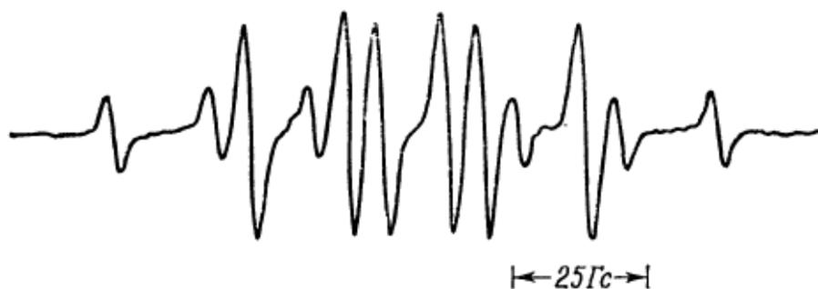
Дать интерпретацию приведенному спектру ЭПР (первая производная) ион-радикала  $\text{NH}_3^+$ . Определить константы сверхтонкого расщепления на каждом из ядер.
