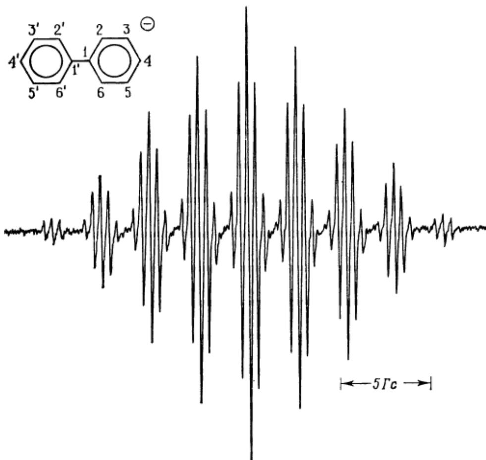
Дать интерпретацию приведенному спектру ЭПР (первая производная) анион-радикала бифенила. Определить константы сверхтонкого расщепления для каждой группы магнитонэквивалентных протонов.
