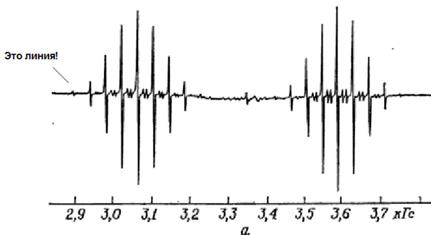
Дать интерпретацию приведенному спектру ЭПР (первая производная) атомов водорода в  $\text{CaF}_2$ . Определить константы сверхтонкого расщепления на каждом из ядер.
