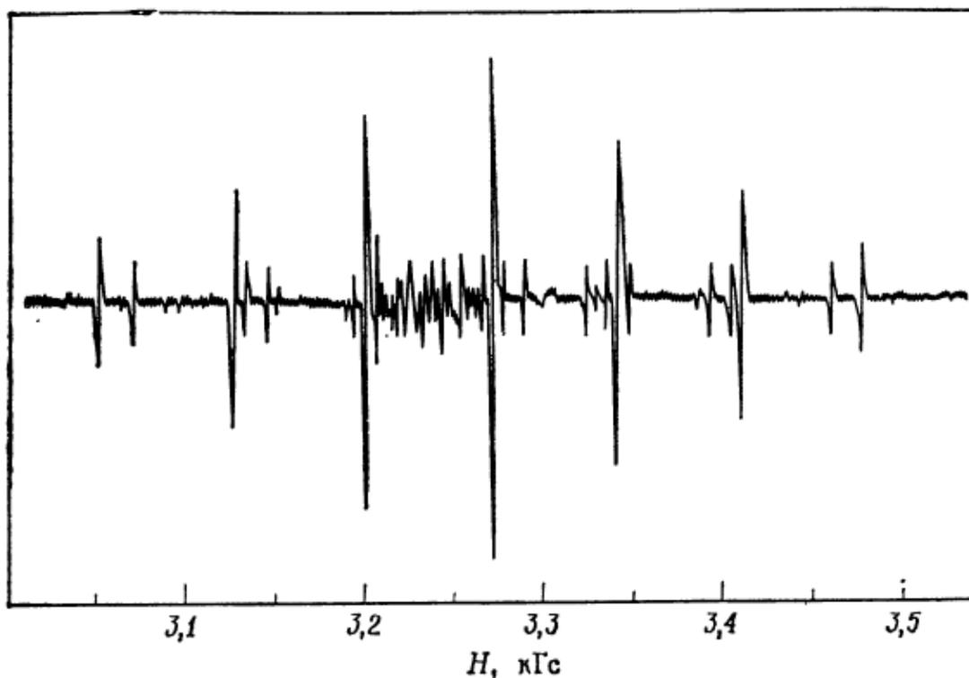
Дать интерпретацию приведенному спектру ЭПР (первая производная)  $\text{Cl}_2^-$  ( $V_K$ ) центра в  $\text{KCl}$ . Исходя из природного соотношения изотопов хлора, рассчитать вероятность образования пар  $(\text{Cl}_{35}-\text{Cl}_{35})^-$ ,  $(\text{Cl}_{35}-\text{Cl}_{37})^-$ ,  $(\text{Cl}_{37}-\text{Cl}_{37})^-$ , выделить линии каждого из центров.
