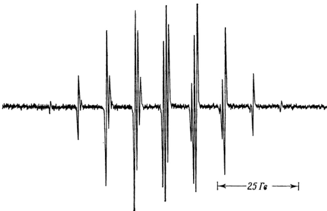
Дать интерпретацию приведенному спектру ЭПР (первая производная) радикала  $(\text{CF}_3)_2\dot{\text{N}}\text{O}$ .
