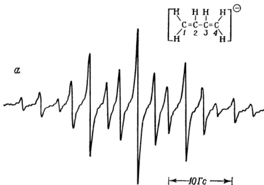
Дать интерпретацию приведенному спектру ЭПР (первая производная) анион-радикала бутадиена. Определить константы сверхтонкого расщепления для каждой группы магнитонезквивалентных протонов.
