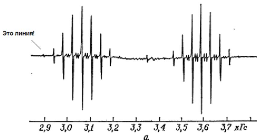
На основании приведенного спектра ЭПР (первая производная) атомов водорода в  $\text{CaF}_2$  схематически (вертикальными линиями с учетом соотношения интенсивностей) изобразить спектр атомов дейтерия в  $\text{CaF}_2$ . Считать, что расщепление на атомах фтора при переходе от водорода к дейтерию не изменяется.
