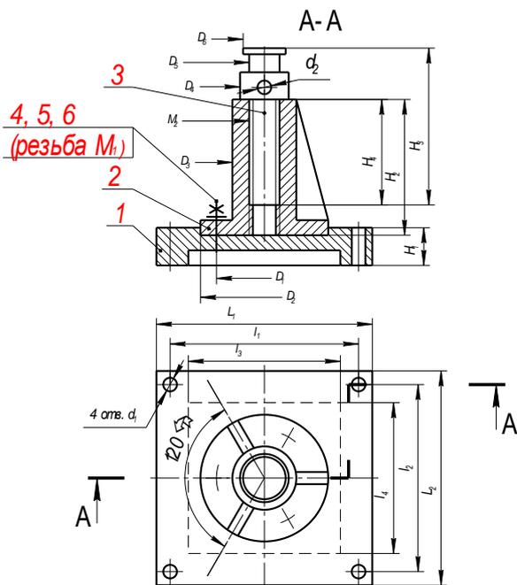
1 - станина, 2 - втулка, 3 - винт, 4 - шпилька, 5 - гайка, 6 - шайба.
