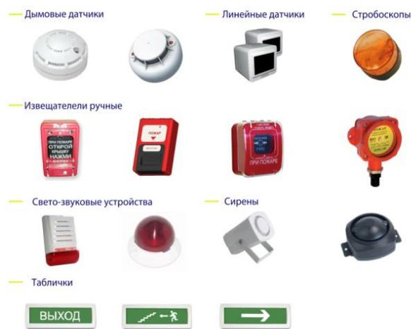
*Дымовые пожарные извещатели* обладают меньшей инерционностью по сравнению с тепловыми. Они бывают точечными и линейно-объемными. Точечные дымовые извещатели используют ионизационный эффект. При попадании дыма в открытую камеру происходит уменьшение электрического тока, в результате чего включается цепь электрического реле. Линейно – объемный дымовой извещатель оптического типа работает по принципу изменения силы света при задымлении.
